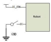
Figure 20. NPN input wiring diagram
