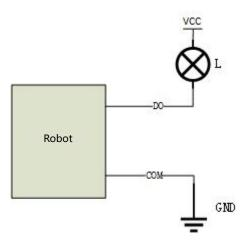
Figure 21. NPN output wiring diagram
