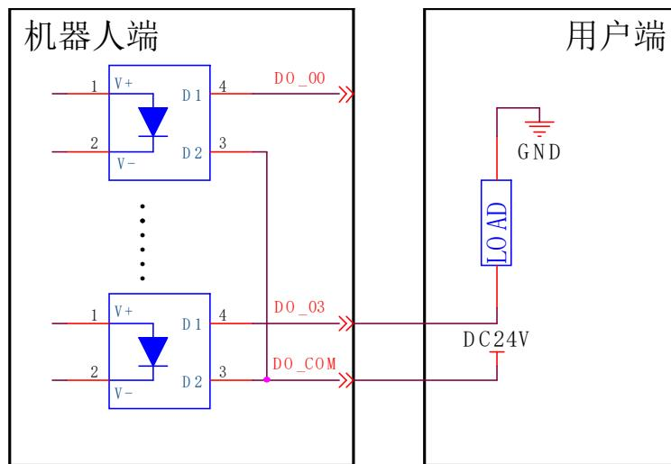
图 6-9 PNP 输出接线示意图
