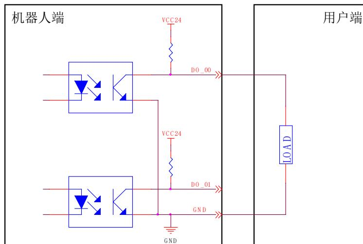
图 6-16 末端输出接口示意图
