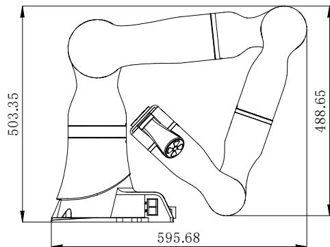
图 5-3 机器人搬运参考尺寸
