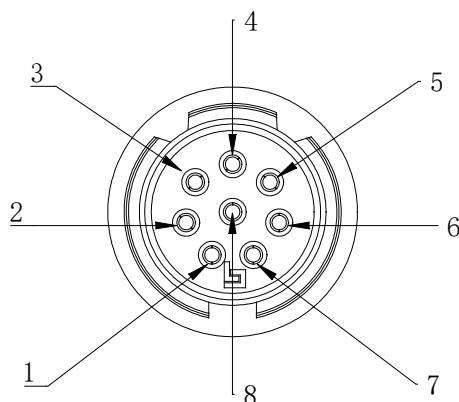
图 6-15 末端圆形连接器接口定义
