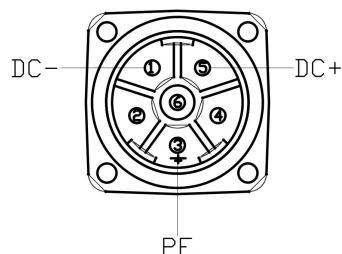
图 6-20 电源输出接口示意图
