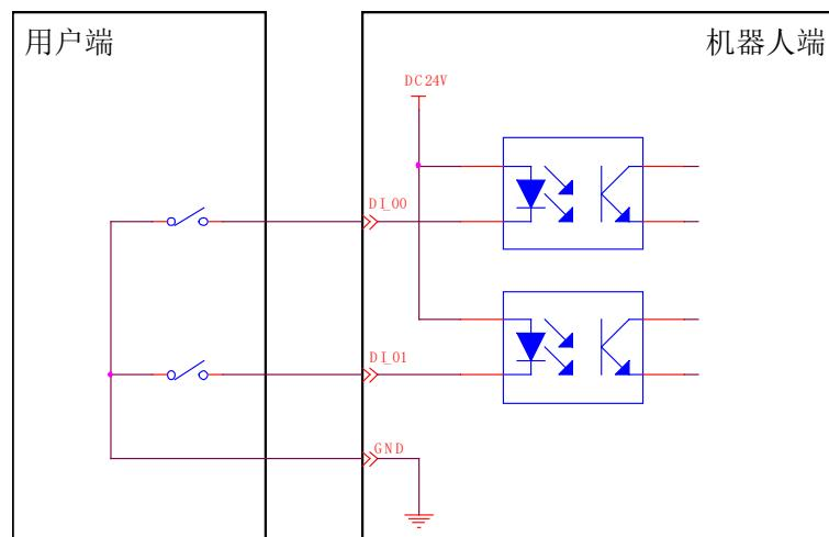
图 6-17 末端输入接口示意图
