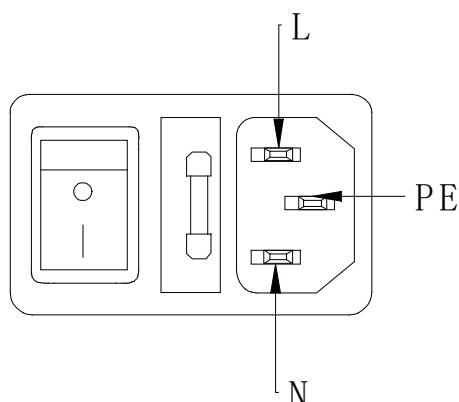
图 6-19 电源输入接口示意图
