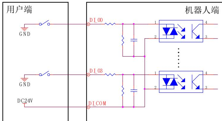
图 6-7 NPN 输入接线示意图
