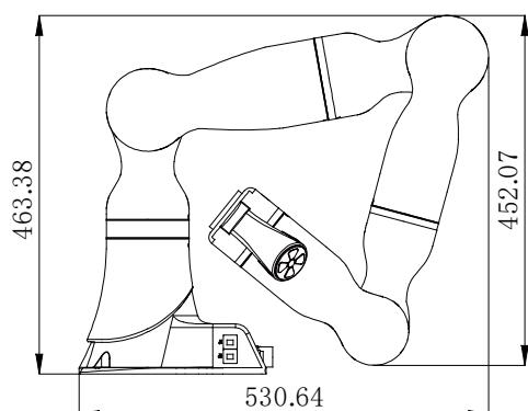
图 5-3 机器人搬运参考尺寸
