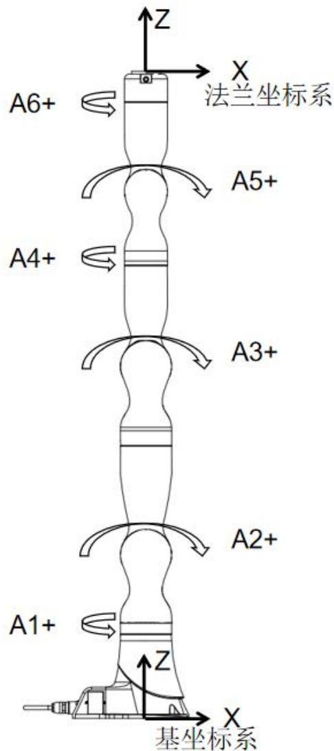
图 3-2 机器人各轴运动方向与坐标系定义
