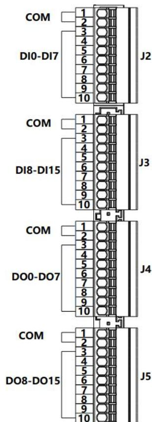
控制柜标配 16 路通用数字输入和 16 路通用数字输出，引脚定义如下：
