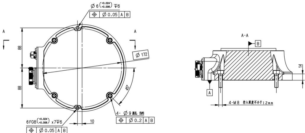
为保证定位准确可在预留的圆柱销孔中使用销钉定位，随后用 4 个 M8X30 的内六角圆柱头螺栓（强度等级 12.9 级）将机器人底座固定在支架上。
