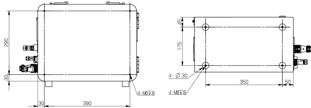
控制柜背面有 4 个 M6 深度 8mm 的螺纹孔，底部有 4 个 M8 深度 8mm 的螺纹孔，可根据现场使用环境选择合适的安装方式进行固定。
