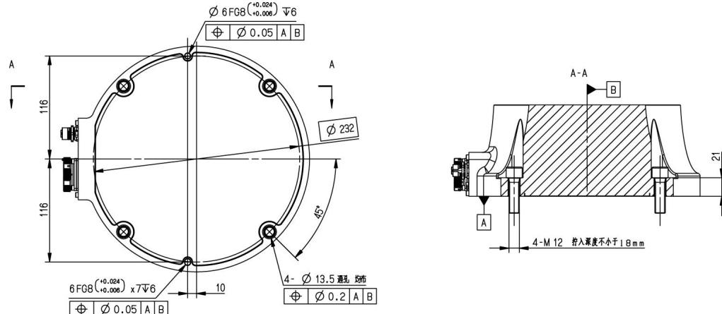
为保证定位准确可在预留的圆柱销孔中使用销钉定位，随后用 4 个 M12X40 的内六角圆柱头螺栓（强度等级 12.9 级）将机器人底座固定在支架上。
