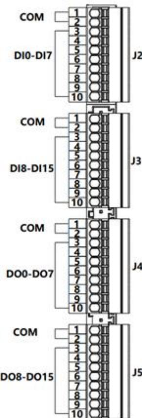
控制柜标配 16 路通用数字输入和 16 路通用数字输出，引脚定义如下：
