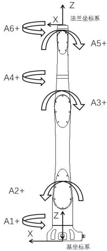
图 3- 2 机器人各轴运动方向与坐标系定义
