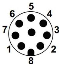
图 6-25 末端圆形连接器接口定义
