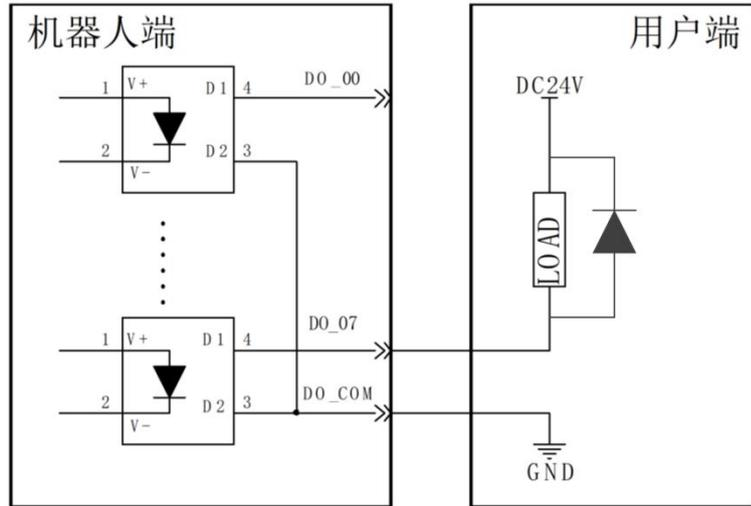
图 6-17 电气原理图
