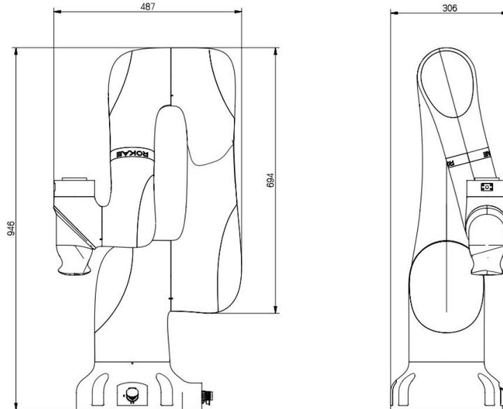
图 5-3 机器人搬运参考尺寸
