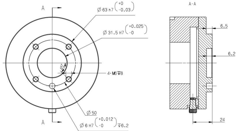
图 5-6 工具法兰安装
