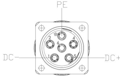
图 6-31 电源输出接口示意图
