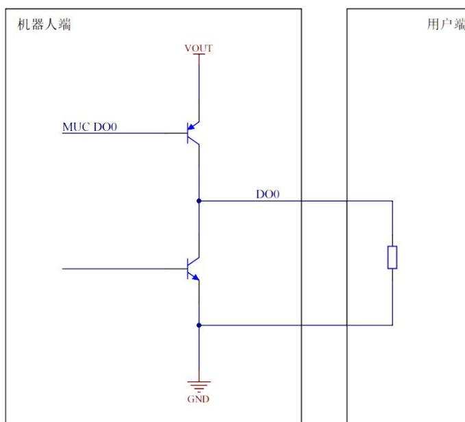
图 6-27 PNP 末端输出接口示意图
