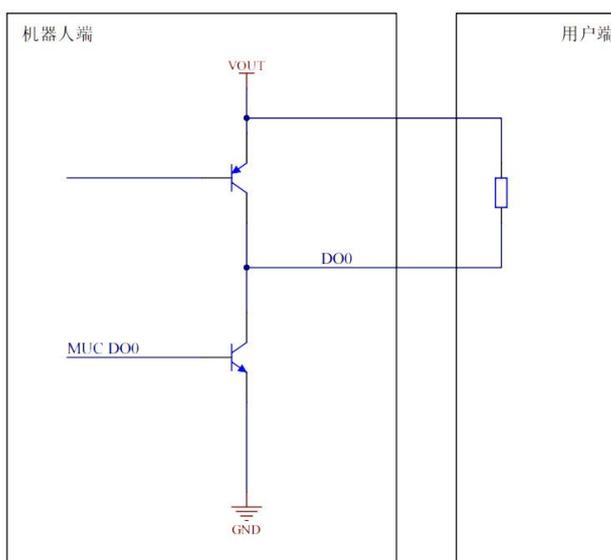
图 6-26 NPN 末端输出接口示意图
