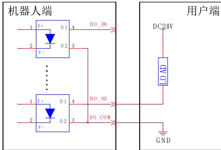
图 6-8 NPN 输出接线示意图
