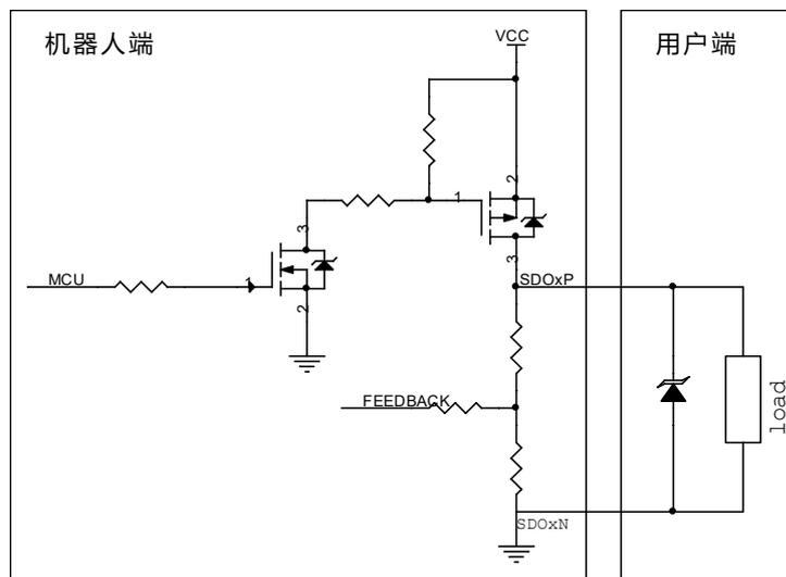
图 6-22 电气原理图
