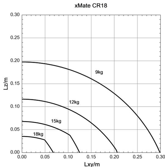
图 4-3 手腕最大允许负载与重心偏移关系图
