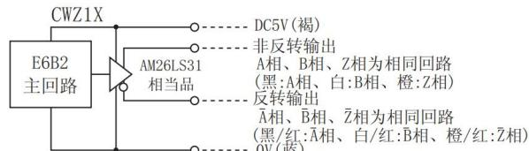
针对此种输出类型的编码器 A/B 相, 将编码器的 A+/A-/B+/B-信号分别对应接入 CTM01A 板卡的 A+/A-/B+/B-引脚即可。
