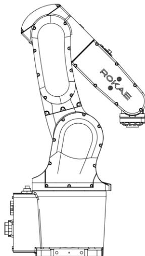
图 26 机器人运输角度
