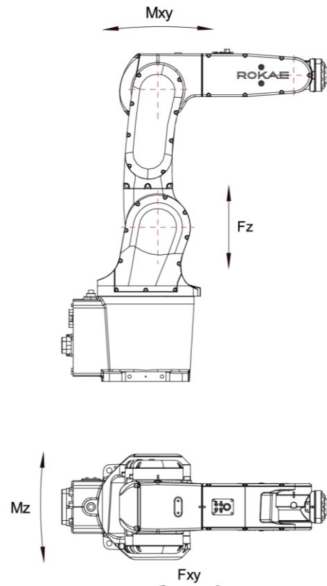
图 34 机器人支反力图
