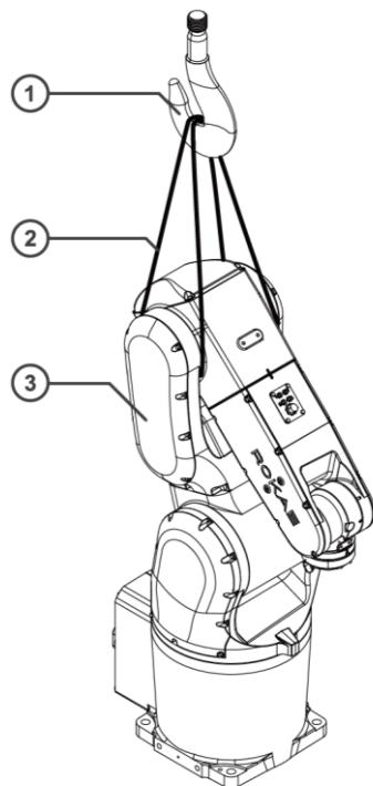
图 28 机器人吊装搬运
