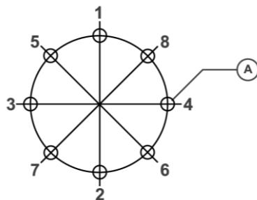
图 47 螺钉拧紧示意图
