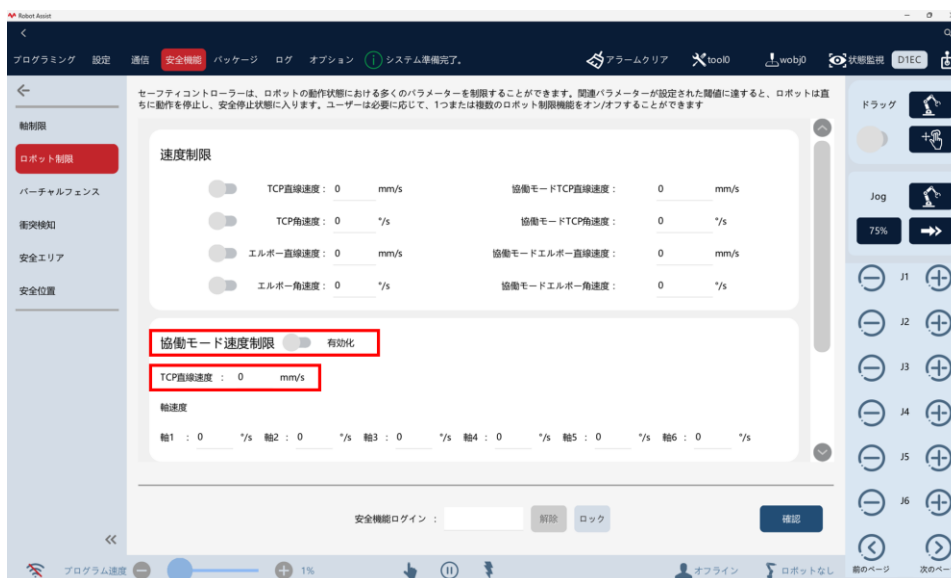
図 6-19 協働モード有効化と制限速度
