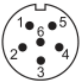
图 6-27 百兆网口定义 引脚定义如下：
