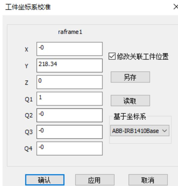
图示：“工件坐标系校准”界面
