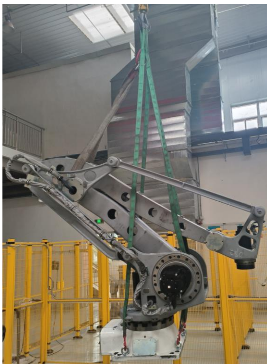
图 13 机器人吊装搬运
