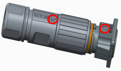
图 6-34 航插对插示意图
