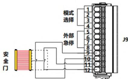
用户可通过此接口，连接安全门设备（光电开关/行程开关/安全光幕等）。例如在使用安全光幕时，因该接口为有源接口，只需将开关输入输出回路连接至安全门接口即可，请参见上图。
