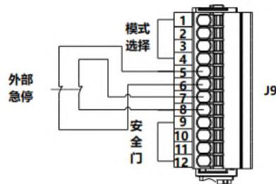
用户可通过此接口，连接急停按钮或急停手柄等。例如在使用急停按钮时，因该接口为有源接口，只需将急停开关输入输出回路连接至外部急停接口即可，请参见上图。
