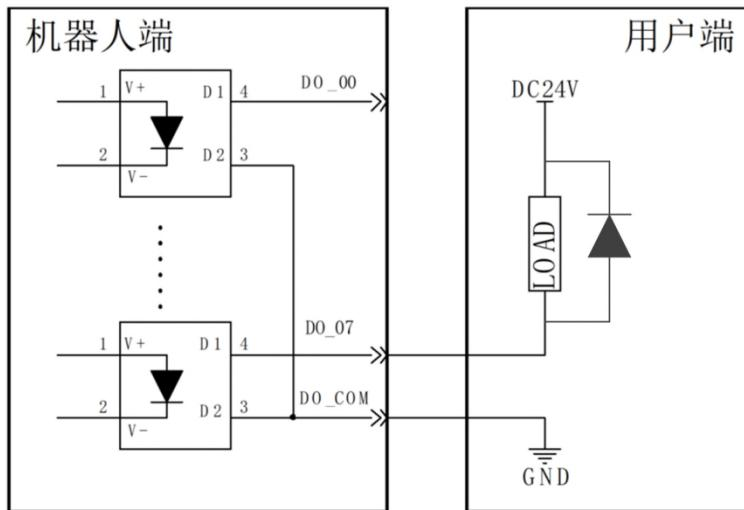
输出高电平有效，将 DO\_COM（公共端）连接到 24VDC，参考下图。
