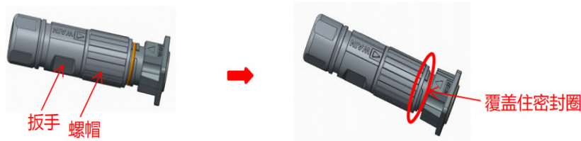
图 6-36 航插对插示意图（注意：切记勿扭动扳手位置，避免插体移位）
