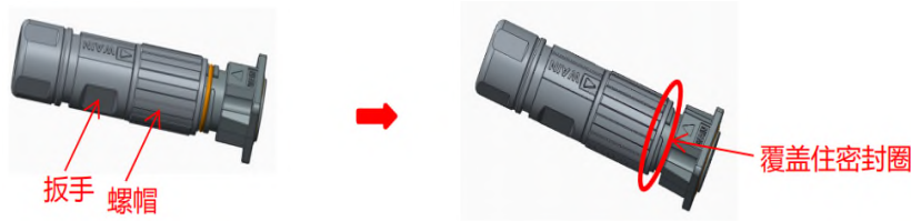
图 6-35 航插对插示意图（注意：切记勿扭动扳手位置，避免插体移位）
