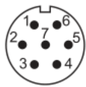
图 6-22 EtherCAT 调试口定义
