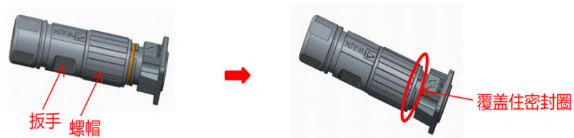
图 6-34 航插对插示意图（注意：切记勿扭动扳手位置，避免插体移位）
