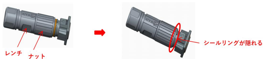
図 6-38 嵌合の概略図 (注意: プラグのずれを避けるために、レンチの位置をひねらないように注意してください)
