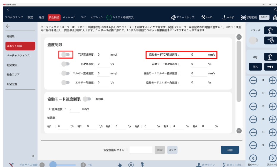
図 6-19 協働モード時の監視速度
