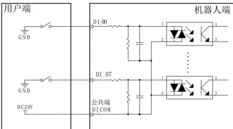
图 6-16 电气原理图
