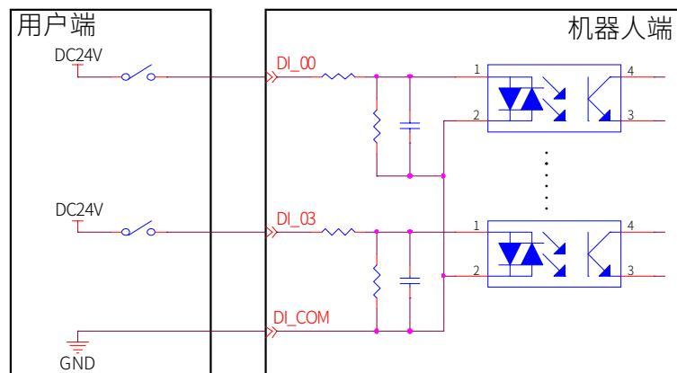
图 6-6 PNP 输入接线示意图
