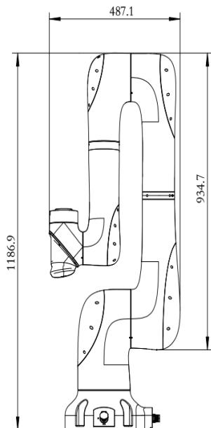
图 5-3 机器人搬运参考尺寸
