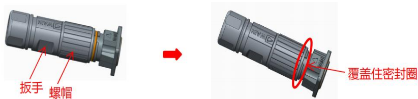
图 6-35 航插对插示意图（注意：切记勿扭动扳手位置，避免插体移位）
