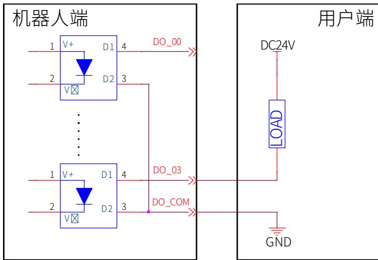
图 6-8 NPN 输出接线示意图
