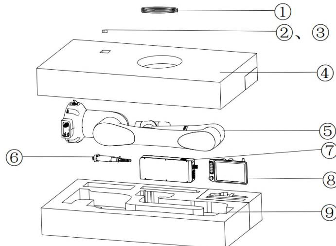
图 5-1 拆箱示意图
