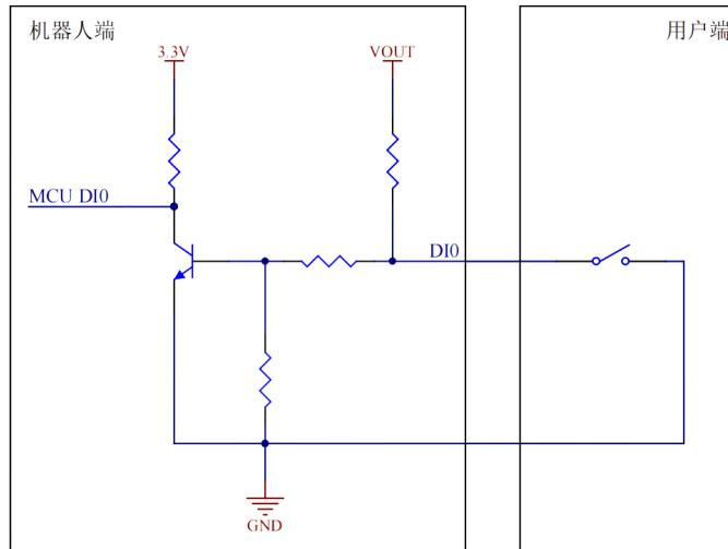
图 6-28 末端输入接口示意图
