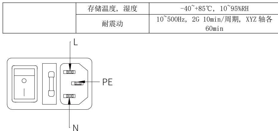
图 6-30 电源输入接口示意图
