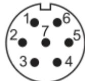
图 6-23 EtherCAT 调试口定义
