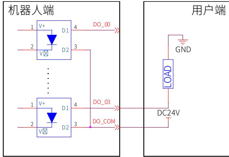
图 6-9 PNP 输出接线示意图
