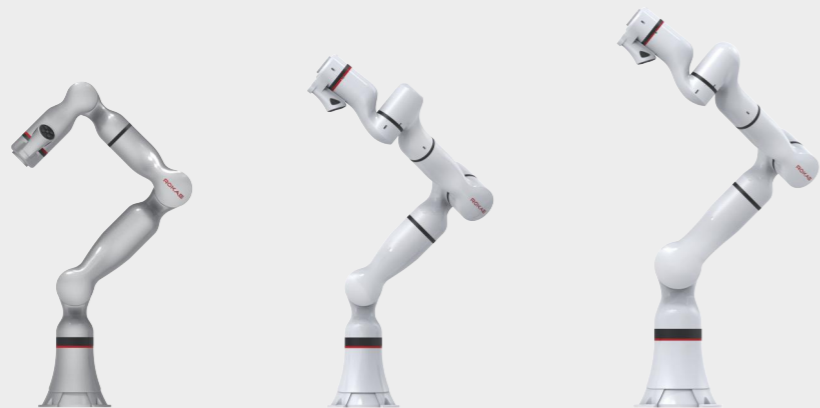
ER3 负载 3kg 工作半径 1010mm
