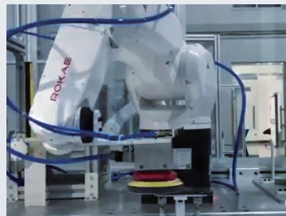
携帯電話等の電子製品の金属製バックパネルの研磨
