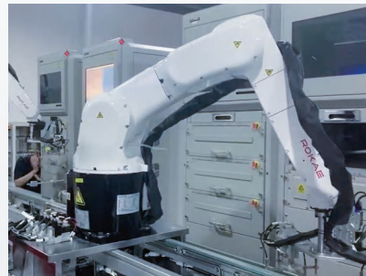
携帯電話等の電子製品の検査装置でのロード・アンロード
