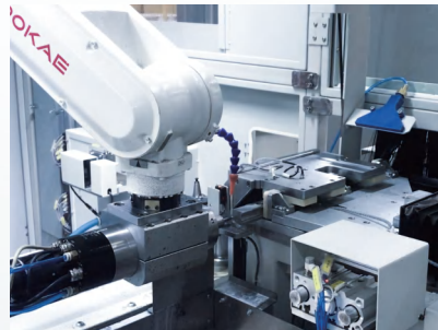
自動車用リニアガイドレールの端面の面取り・バリ取り
