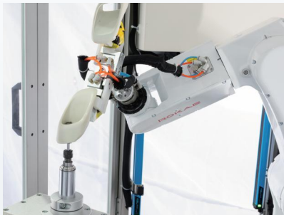
ドアハンドルやステアリングホイール等の自動車内外装プラスチック部品の研磨・バフ研磨
