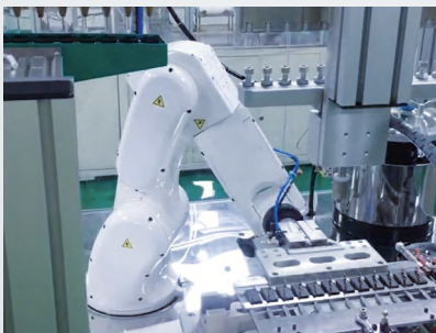
リレー等の電子部品のパッケージに接着剤を塗布
