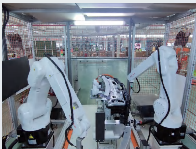
自動車フロントエンドモジュールの多仕様製品に対応可能なフレキシブル自動検査
