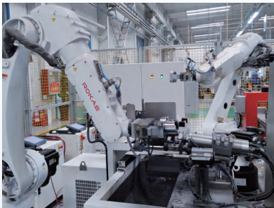
ピストン製品（バルブ、オイルホール、内側のピンボス等の複雑な構造を含む）を全面かつ精細に研磨・バリ取り
