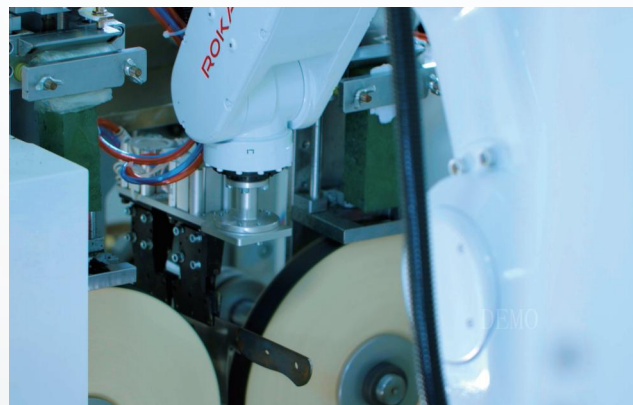
刃物の刃付けの自動化
