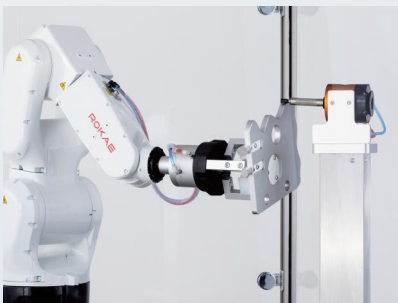
鋳鉄成形部品、アルミニウム-マグネシウム合金ダイカスト部品、スチール製機械加工部品の研磨・バリ取り
