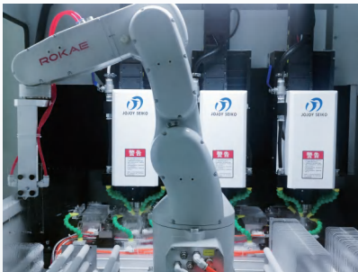
電子製品のカバーガラス板を加工する彫刻ミリング装置でのロード・アンロード
