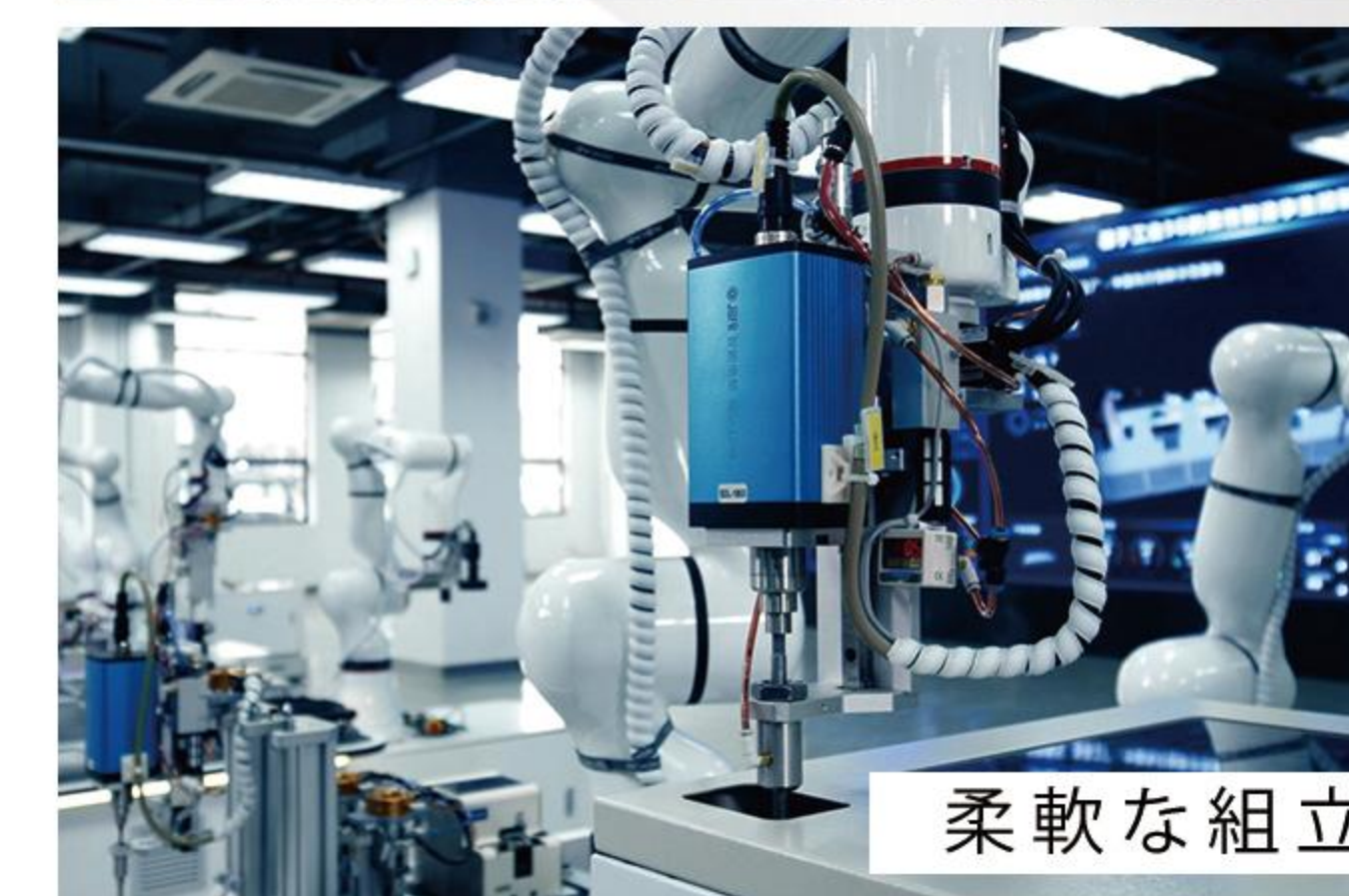
ボルトの締め付け
