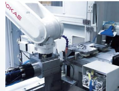
汽车直线导轨的不同端面的倒角、去毛刺
