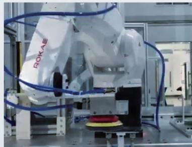
手机等电子产品金属背板的打磨抛光
