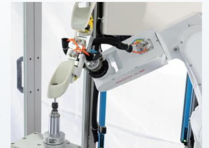
车门把手、方向盘三幅等汽车内外饰塑胶件的打磨抛光
