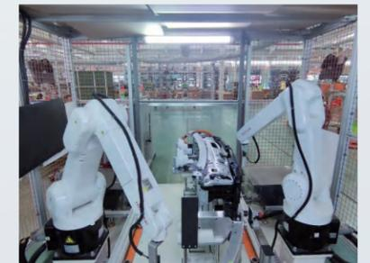
汽车前端模块不同型号产品的柔性自动检测
