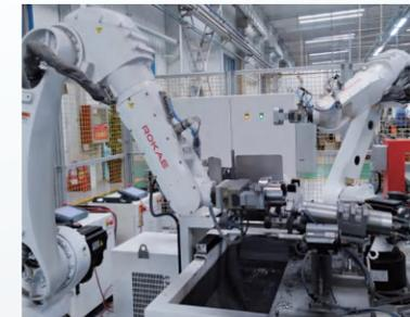
活塞产品(包括气门、油孔、内侧销孔等复杂部位)全面精细的打磨去毛刺
