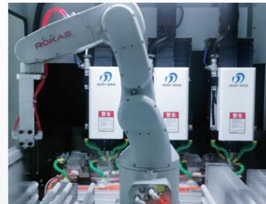
电子产品玻璃盖板加工的精雕机上下料
