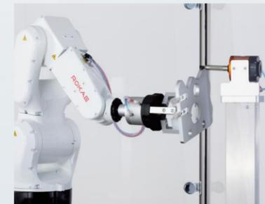
铸铁成型件、铝镁合金压铸件、钢制机加工件的打磨去毛刺
